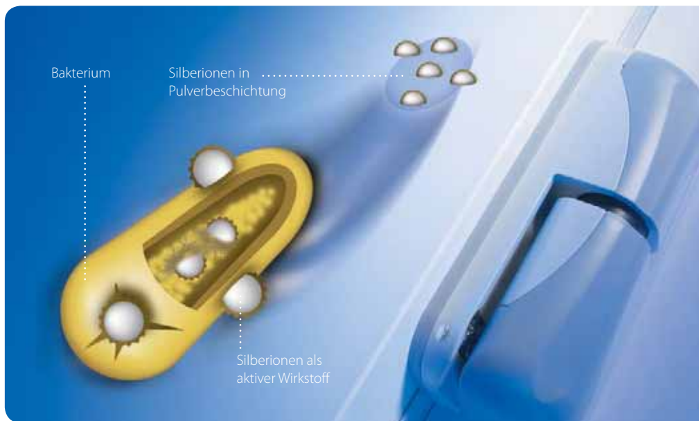
Ionen-Austausch durch Einwirkung von Umgebungsfeuchtigkeit
