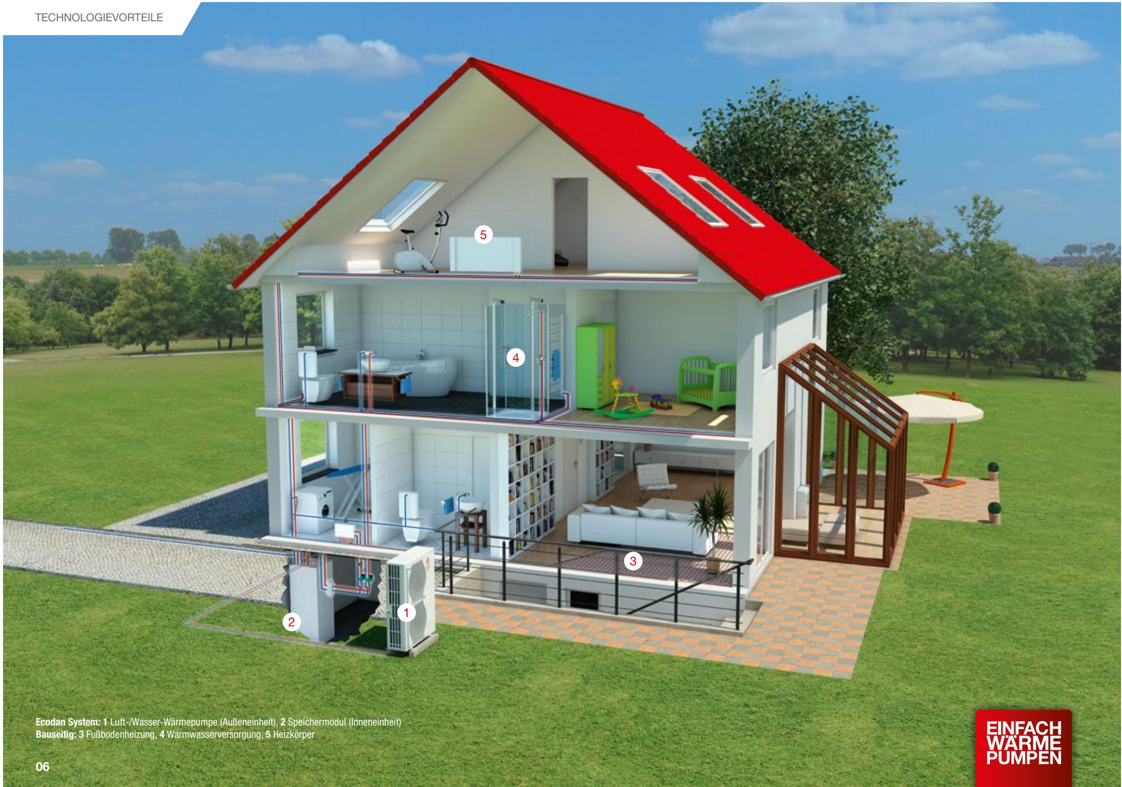
**Ecodan System:** 1 Luft-/Wasser-Wärmepumpe (Außeneinheit), 2 Speichermodul (Inneneinheit)
